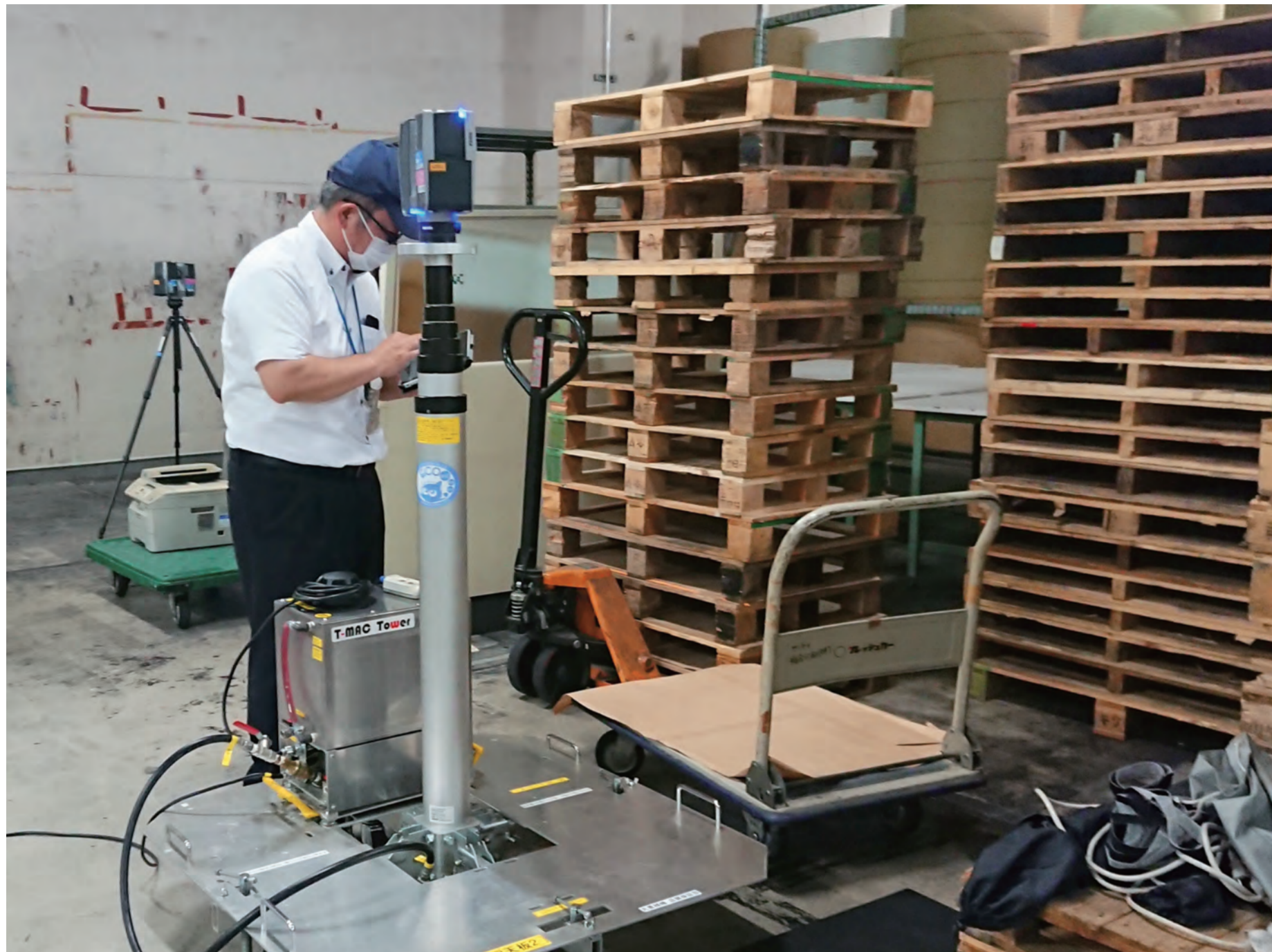
工場で使われた3Dスキャナー。室内をさまざまな角度から撮る＝大阪市此花区(デジタル総合印刷提供)
